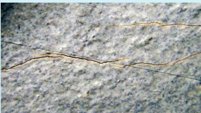
Rissbreitenermittlung mit Rissbreitenmesslupe
