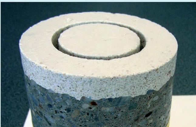
Bohrkernentnahme für Haftzugprüfung im Labor mit vorgebohrter Nut.
