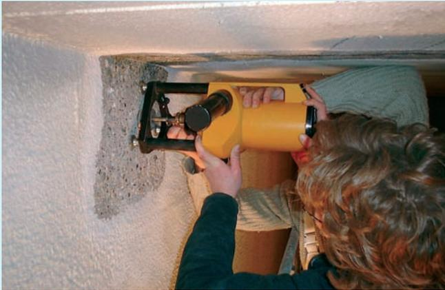
Bei der Entnahme von Bohrkernen für im Labor durchzuführenden Haftzugprüfungen darf der Verbund zwischen den Schichten bei der Bohrkernentnahme nicht gestört werden. Dies kann vermieden werden, wenn die Nut für die Haftzugprüfung vor der Bohrkernentnahme hergestellt wird.
