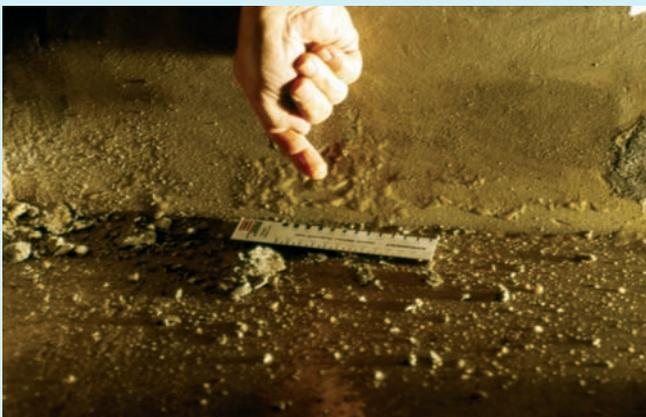
Biofilm verursacht durch organische Inhaltsstoffe im Konstruktionsbeton (Diffusionsprozesse durch die Beschichtung)
